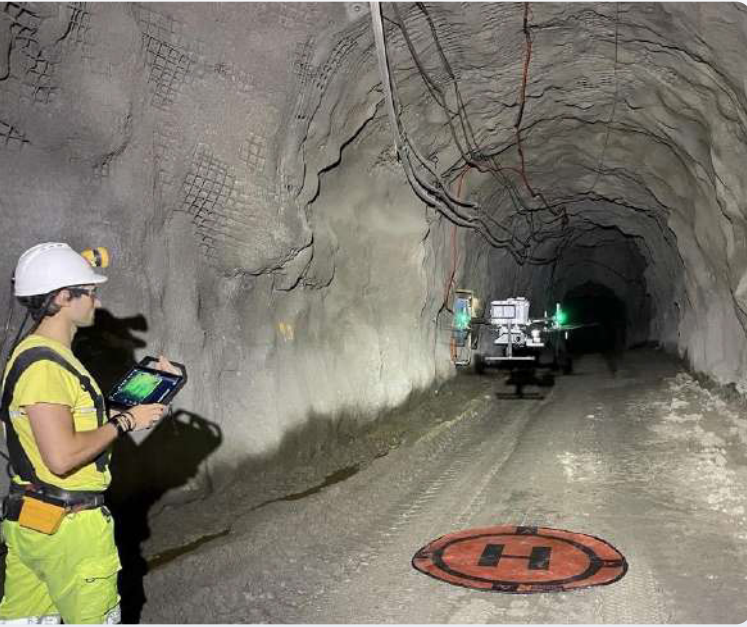
Exyn Nexys, DJI350 ile otonom taramayı destekliyor.
